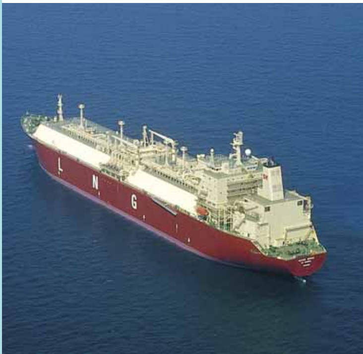
Méthanier transportant du GNL (Gaz Naturel Liquéfié)
